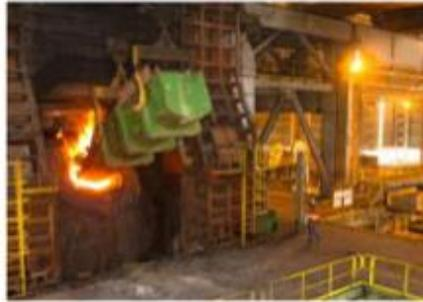
Etapa de processo de produção do aço onde ocorre o refino primário, ou seja, a remoção do carbono contido no ferro-gusa através de injeção de oxigênio no banho com uma lança supersônica para produção do aço líquido
